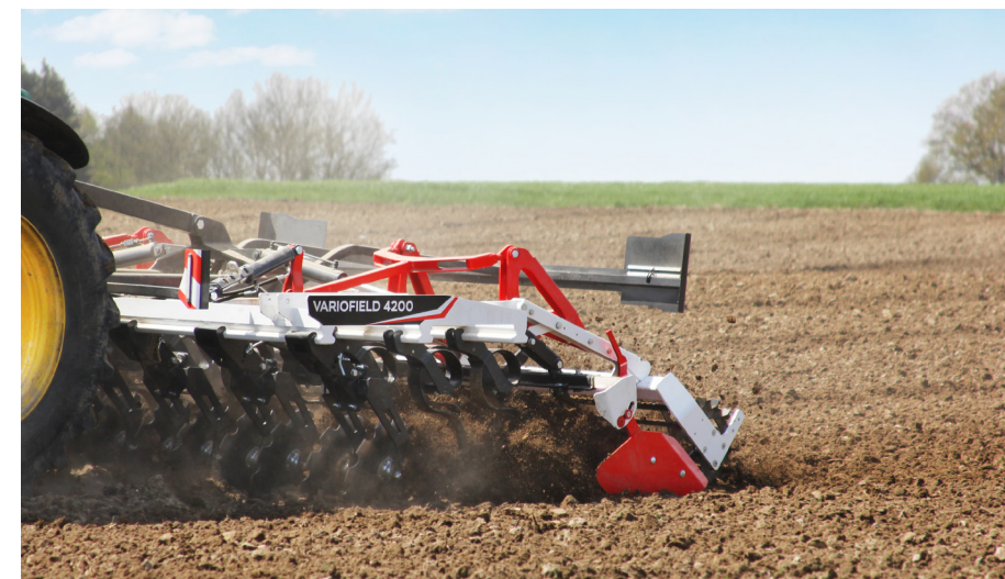
VF4200 mit Scheiben-Zinkenkombination zur Saatbettbereitung für Mais
